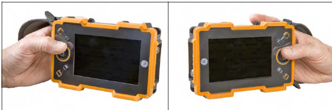
Rysunek 3: Defektoskop USM Go w orientacji leworęcznej i praworęcznej
